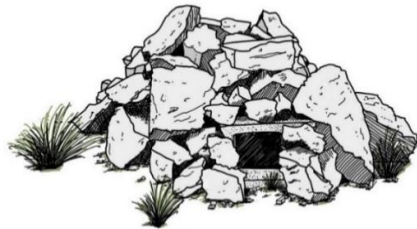
Figure 53 : Pierrier aménagé sur une base de parpaing creux
